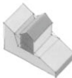
La maison sur un décaissement du terrain trop important oblige à tenir le talus arrière par un mur de soutènement lourd et coûteux. Ce type d'implantation réduit considérablement l'apport de lumière naturelle dans les pièces d'habitation.
